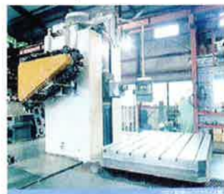
工場内のフロア型横中ぐりフライス盤
