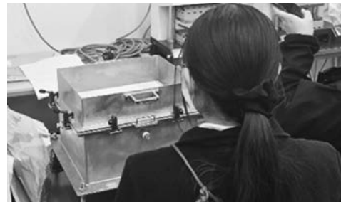
小型脱水装置を用いたCNF脱水工程
