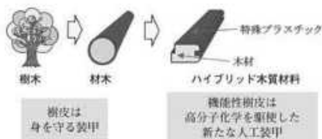
図1. ハイブリッド木質材料のコンセプト
