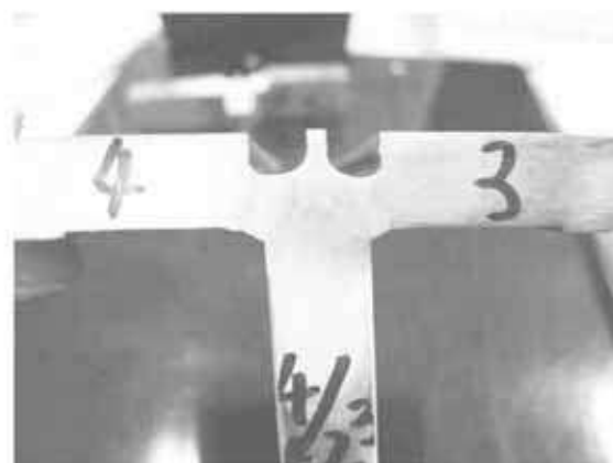
写真—2 綺麗に裏波が出たT継手
