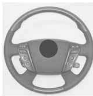
新しく開発した含浸工法によるハンドル
