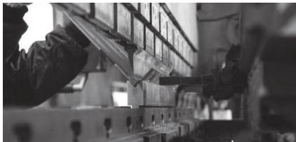
特に板厚1.6~6.0mmの薄板板金技術では広い面積の壁面も最小限の歪で製作致します。また、曲面、複雑な曲げ形状にも対応でき、それらの歪も最小限に抑えます。
