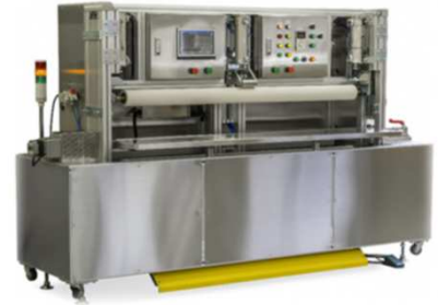
【CFRPパイプ材自動巻き付け装置】
