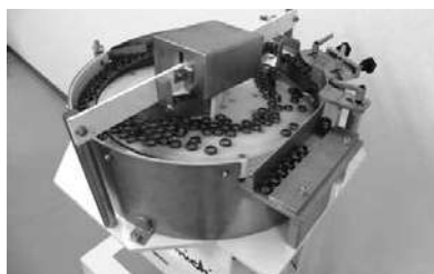
無振動の回転円盤式部品供給装置「リングラン」 2005年 第一回ものづくり日本大賞 優秀賞を受賞
