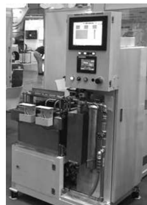
超音波を用いた気密容器漏れ検査装置「バブルウォッチャー」
