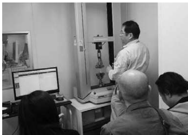
精密万能試験機で混合シートの引張強度試験
