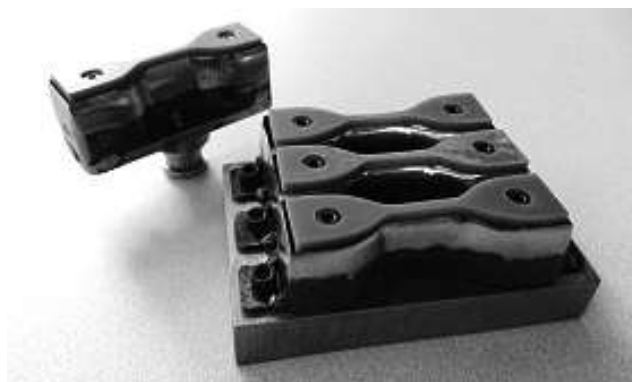
JIS K6251-3 ultimate 引張り試験片抜き刃 (バネ内蔵吐き出しタイプ)
