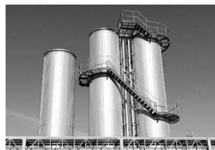
【EGSB処理方式(酸生成槽/反応槽)】
