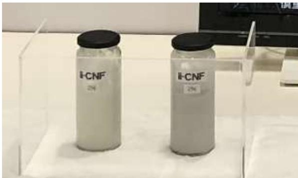
今治タオル製造工程で出る落綿(廃材)から製造するCNF (iCNF)を開発した。
