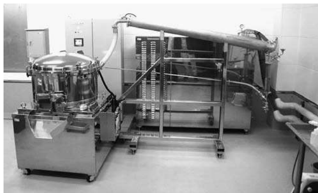
減圧蒸留型抽出装置（バッチ式）
