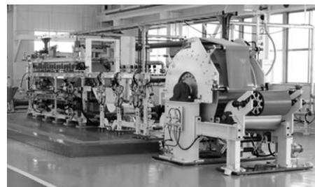
【CNF連続脱水・シート化装置】
