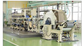
【CNF連続脱水・シート化装置】
