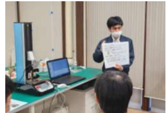
引張試験機による 塗膜物性の評価
