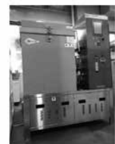
図1 二酸化硫黄ガス腐食試験機(バッチ式)の外観写真
