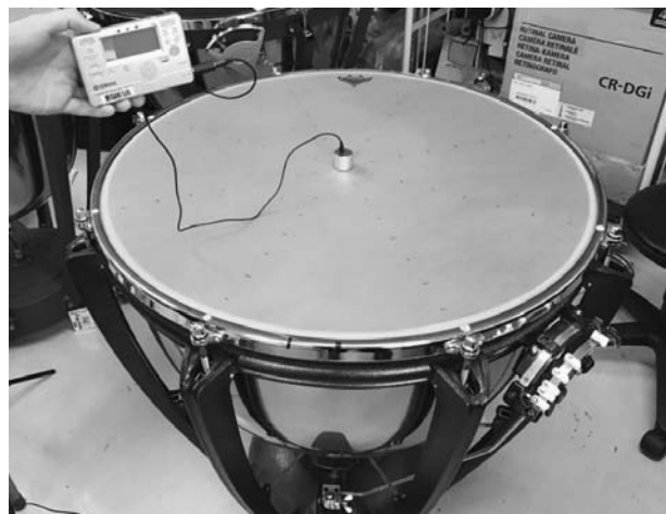
開発したチューニングアダプタによるチューニングの様子
