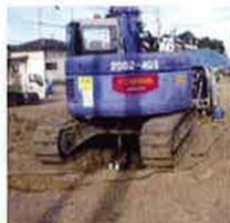
重機を使った平板荷重試験
