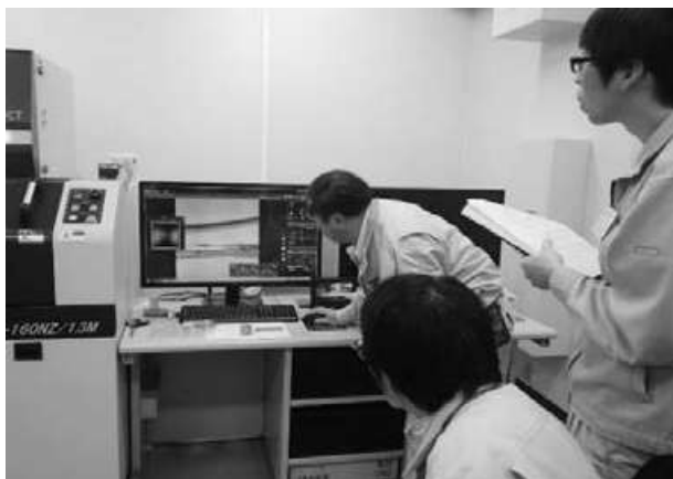
X線CT観察装置で混合シートの凝集物の透視・観察
