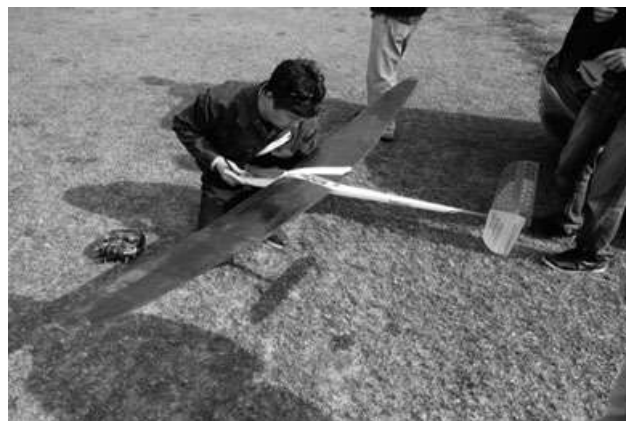
主翼を小型固定翼無線操縦飛行機に組み込み
