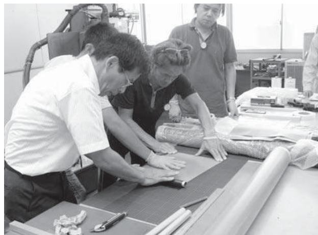
CFRP自転車プロジェクトにおけるCFRPシート成型実習
