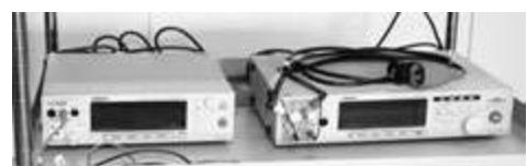
アース導通・漏洩電流試験器
