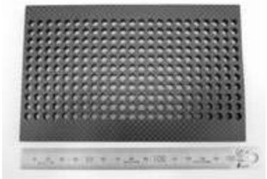
CFRPの穴あけ加工例
