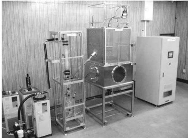
工業用マイクロ波反応装置
