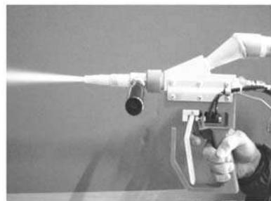
試作した洗浄用ノズルの一例
