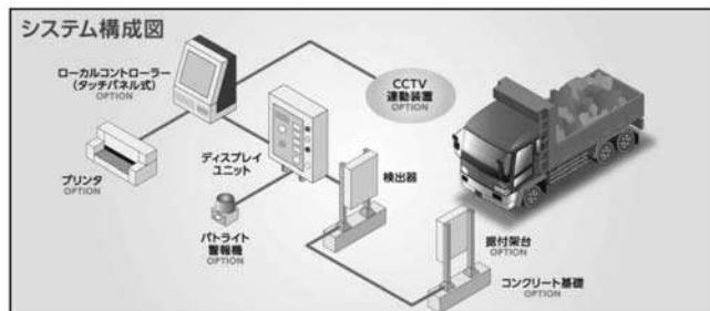
トラックスケール用放射線測定器のシステム構成図
