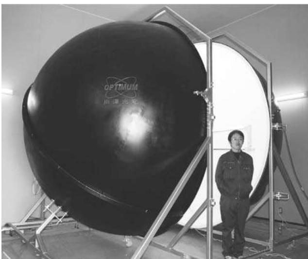
図1：全光束測定装置 OPTIMUM社 ISP3000
