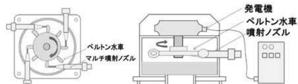
図1 ペルトン方式(落差:大、流量:中～大)
