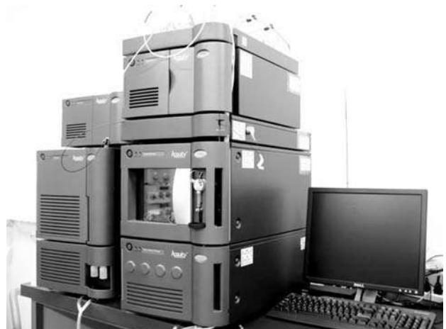
図3：液体クロマトグラフ質量分析装置
