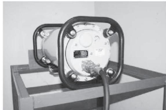
図1：工業用X線透過装置
