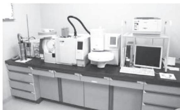
図2：四重極ガスクロマトグラフ質量分析計
