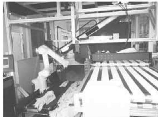
洗濯物ハンドリングシステム試作ロボット
