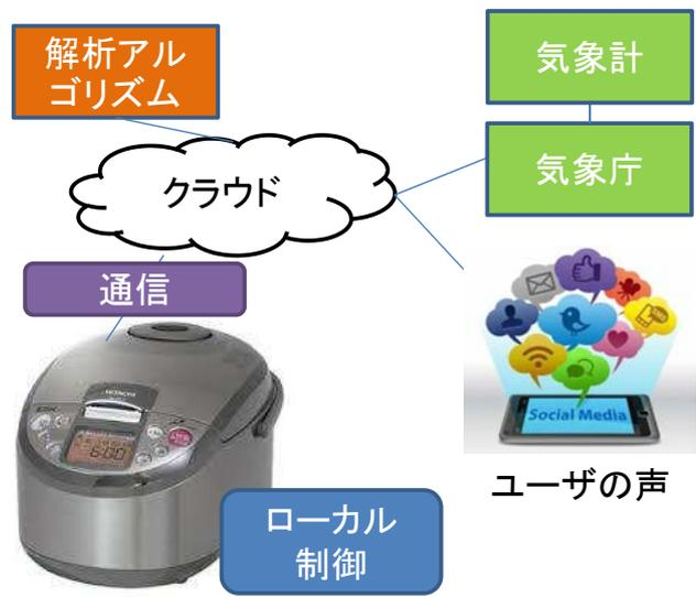
センサーや解析アルゴリズムをクラウド側に分担させ、装置は通信機能とローカル制御のみを分担させる。
