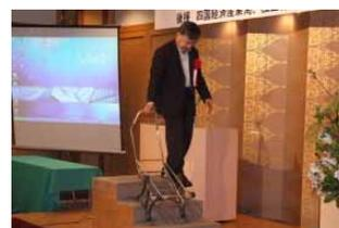
ユニークな形状で、デザイン性も高く、個性的である。従来の丸い車輪と比較すると、内ぞりカーブ面を階段の角に滑らせて昇降するので、車軸の上下動が少なく段差をスムーズに昇降可能となる。
