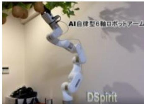
同製品はあらかじめ動きを教えて動作する従来のもの（ティーチング）と違い、アームロボット自らが対象物の空間座標を把握し、自らの関節角度を自律制御して動作を行う特性を持ち、AIによる物体認識とシンプルな機構での自立制御を実現し、価格を1/2～3/2程度に抑えられるものともなっている。
